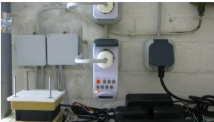
Sie erlaubt über zwei steuerbare Stromanschlussmöglichkeiten sowohl die innere Luftumwälzung als auch die Abluftabsaugung entweder zeitlich oder auch thermisch zu regeln.
